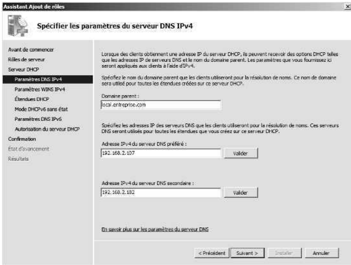
Figure 19-1 Configurer les paramètres DNS par défaut pour les clients DHCPv4.
