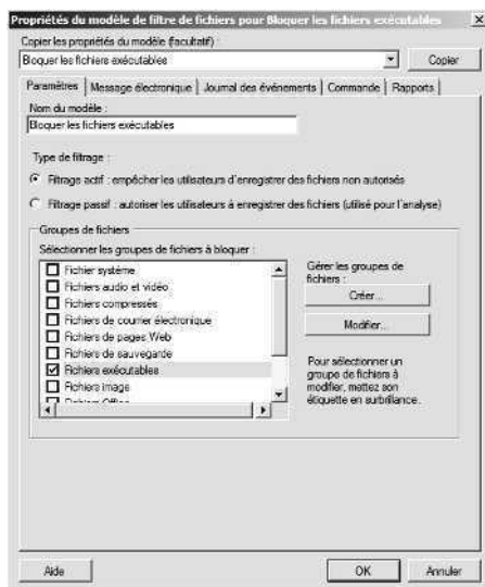
Figure 14-4 Servez-vous des propriétés du filtre de fichiers pour configurer le type de filtrage, les groupes de fichiers auxquels s'appliquent le filtre et les notifications.
