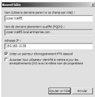
Figure 20-4 Créez des enregistrements d'adresses et de pointeurs simultanément avec la boîte de dialogue Nouvel hôte.
