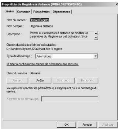
Figure 4-8 Utilisez la liste déroulante Type de démarrage de l'onglet Général pour configurer les options de démarrage des services.
