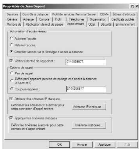
Figure 11-7 Les privilèges d'appels entrants contrôlent l'accès au réseau à distance.
