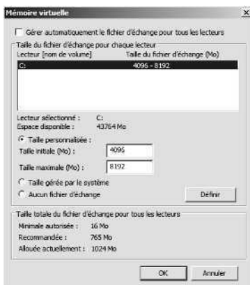
Figure 3-4 La mémoire virtuelle augmente la quantité de RAM sur un système.
