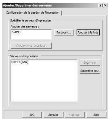
Figure 18-2 Ajoutez des serveurs d'impression à la console Gestion de l'impression pour les gérer et les surveiller.
