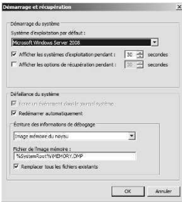
Figure 3-6 Configurez les procédures de démarrage et de récupération du système dans la boîte de dialogue Démarrage et récupération.
