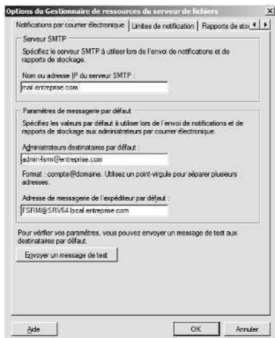
Figure 14-2 Définissez les notifications par courrier électronique et les paramètres globaux des ressources de fichiers sur l'onglet Notifications par courrier électronique.
