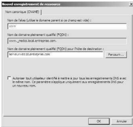
Figure 20-6 Lorsque vous créez un enregistrement CNAME, assurez-vous d'utiliser le nom d'hôte de partie unique, puis le nom d'hôte complet.
