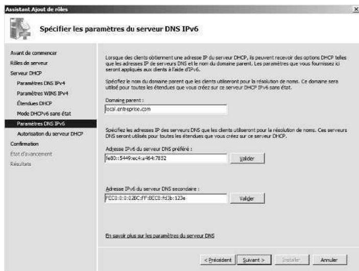
Figure 19-2 Configurez les paramètres DNS par défaut pour les clients DHCPv6.
